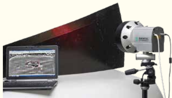
Рис. 3. Внешний вид шерографического оборудования на примере Dantec Dynamics FlawExplorer
