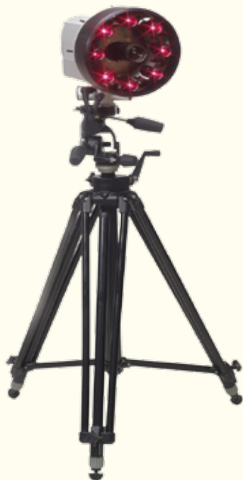
Рис. 4. Внешний вид штативной шерографической системы Dantec Dynamics FlawExplorer
