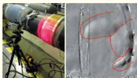
Рис. 7. Контроль элемента трубы с углепластиковым покрытием
